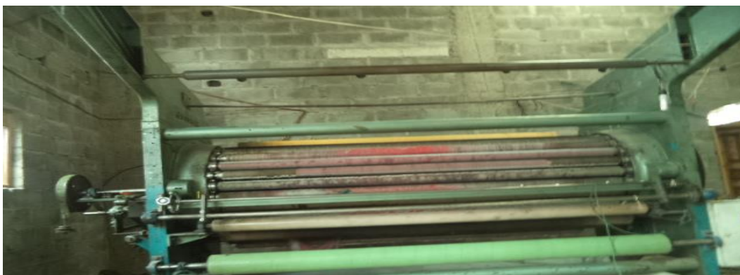
GRÁFICO N° 51 Maquina perchadora marca GESSNER
