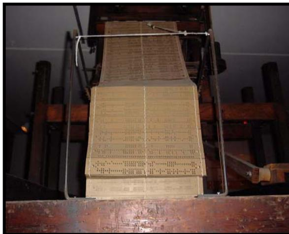
**Figura 2.1** Tarjetas perforadas
