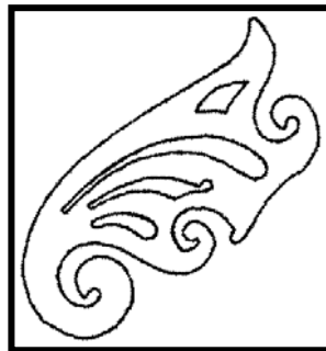
Figura 4.6 Se muestra una de estas plantillas, o curva francesa
