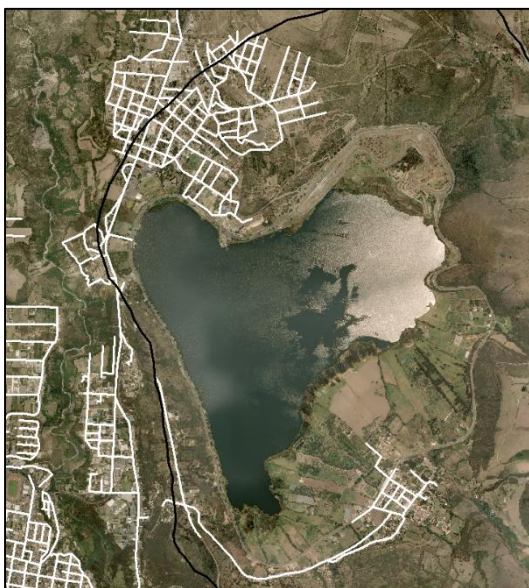
Figura 14 Red de Alcantarillado que descarga al Lago Yahuarcocha
