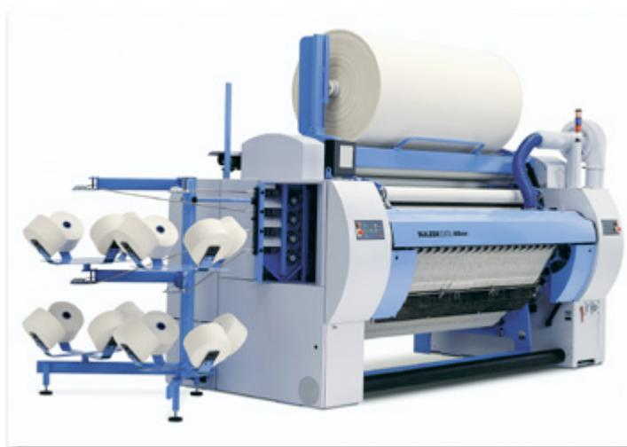
**Figura 1.43. Máquina de tejer multifásica Sulzer Textil M8300, de Sultex**
