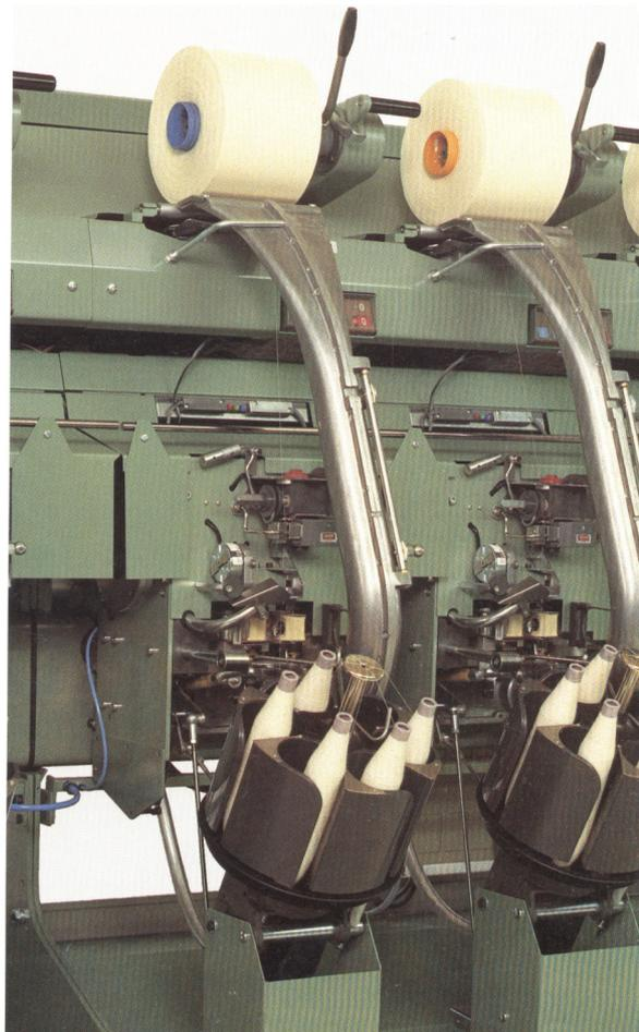
Las bobinadoras automáticas se caracterizan por producir un enrollamiento del hilo con precisión, el cual es exigido por telares modernos.
