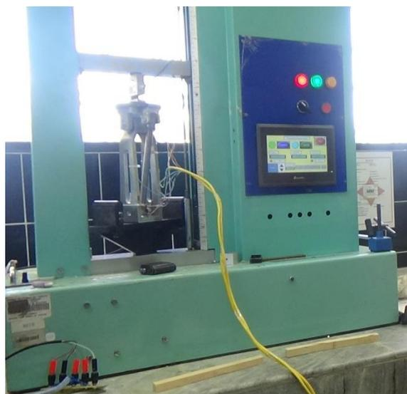
Figura 3.20. Ubicación del mecanismo en la máquina de ensayos.
