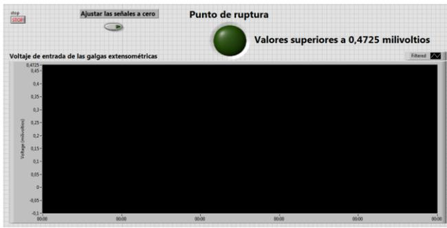
Fig. 13 Interfaz de usuario para visualización de las curvas de deformación.
