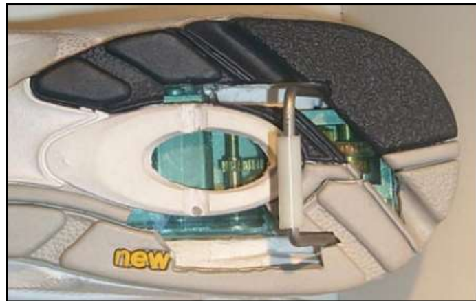
Figura 2.2 Sistema de impacto en el talón Fuente: (Hayashida, 2000)
