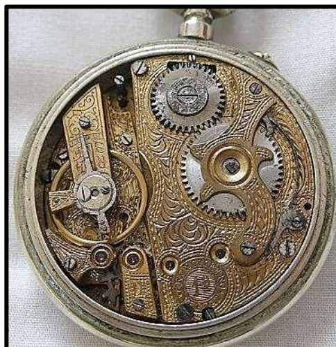
Figura 2.13 Reloj de bolsillo con engranajes rectos
