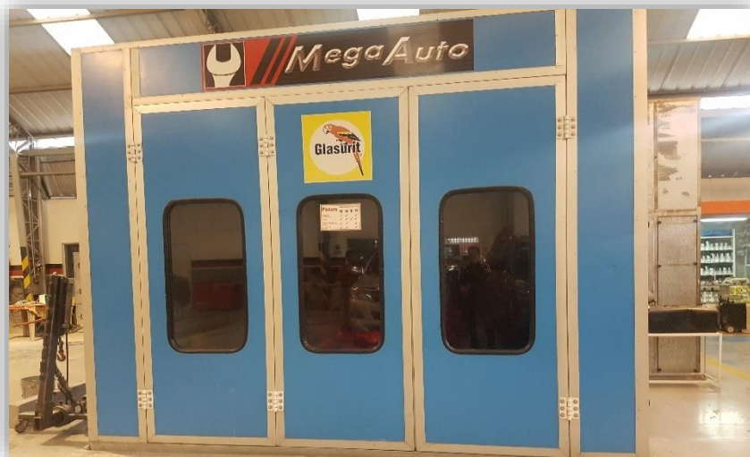
Área de pintura al horno
