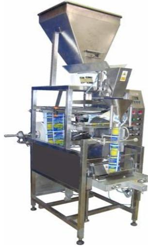
Empacadora automática con sistema de pesaje de una balanza, para embolsado de productos granulados o sólidos
