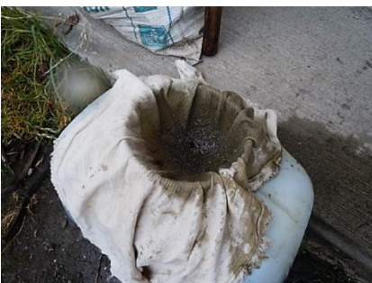
Fotografía 15. Filtración del biol
