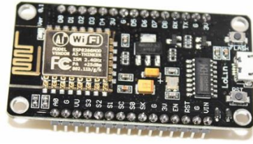
Figura 3.6 Módulo wifi ESP8266MOD 1 Fuente: Propia
