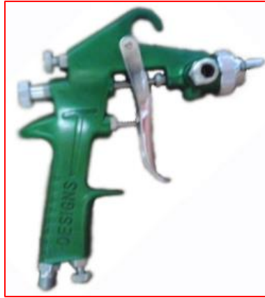
ILUSTRACIÓN 2. 6. Pistola pulverizadora de compuesto R.
