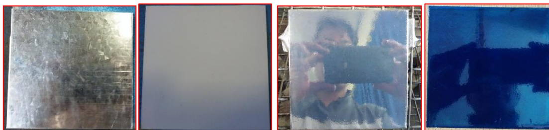
ILUSTRACIÓN 3. 7. Proceso de cromado probeta de metal.
