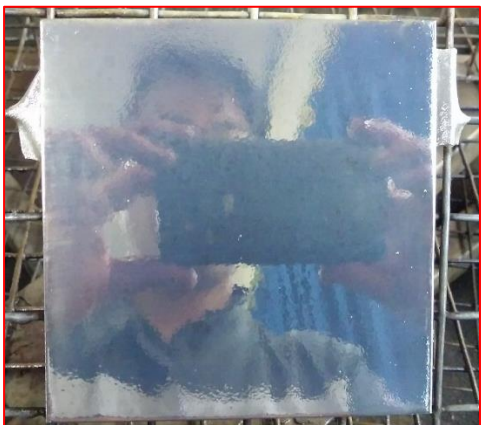
ILUSTRACIÓN 3. 9. Probeta de metal, acero galvanizado.
