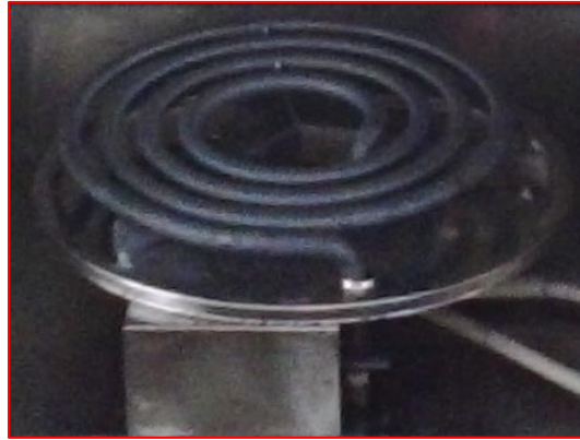
ILUSTRACIÓN 2. 39. Resistencia eléctrica para calentamiento de aleación de níquel-cromo 80-20.
