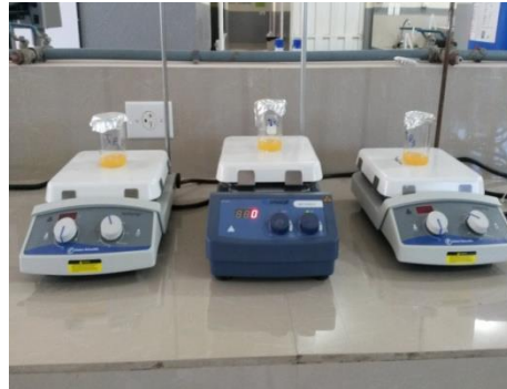
Agitación magnética de la solución durante 30 min- 700 rpm
