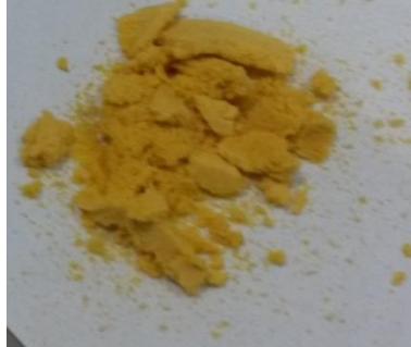
Liofilización de la muestra de uvilla congelada a -15^{\circ}\text{C}
