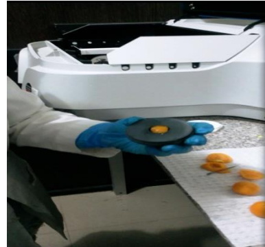
Colocar la muestra de uvilla en la celda de medición
