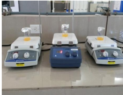
Agitación magnética del extracto 15 min-750rpm
