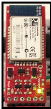
Figura 96. conexión establecida entre el módulo BlueSMiRF SilverRN-42 y el ordenador
