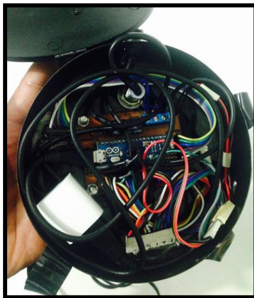
Figura 64. Cableado interno del dispositivo CPD
