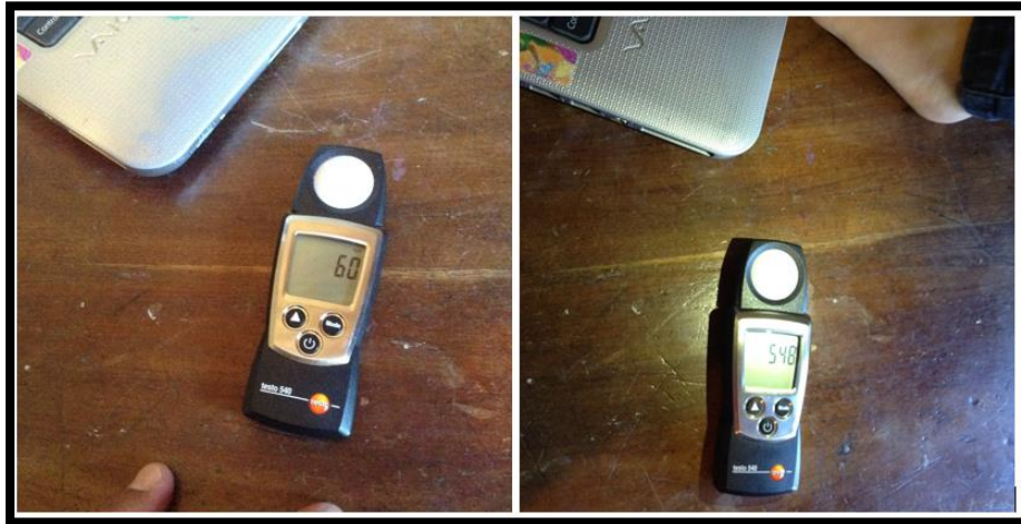
Figura 89. Medición de alucinación con iluminación del dormitorio resultando 60 lux para el área de trabajo.
