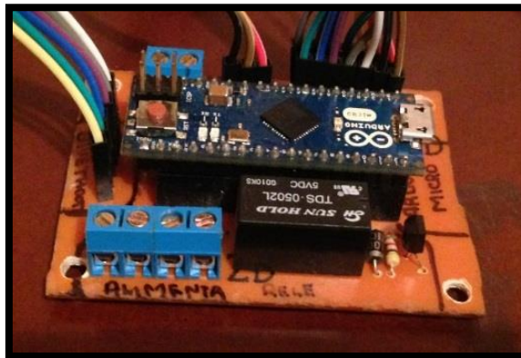
Figura 57. Montaje de elementos y la placa Arduino Micro
