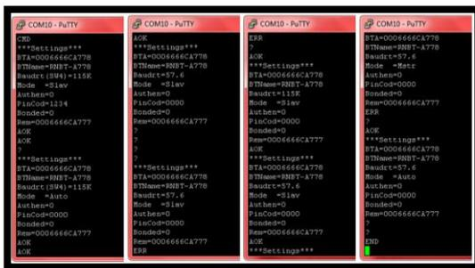
Fig. 8 Pantallas de configuración modulo Módulo BlueSMiRF Gold RN-42
