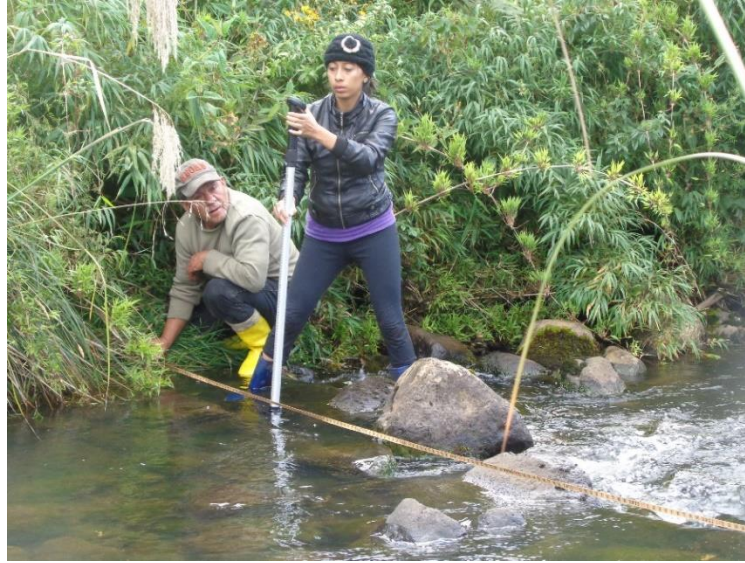
Figuras 2. Medición de caudales con Molinete mecánico Fuente: Autora
