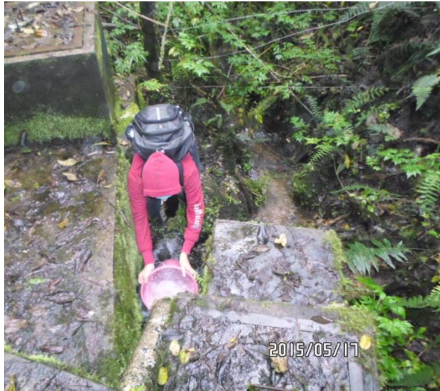
Figuras 5. Medición de caudales con el método de aforo volumétrico Fuente: Autora
