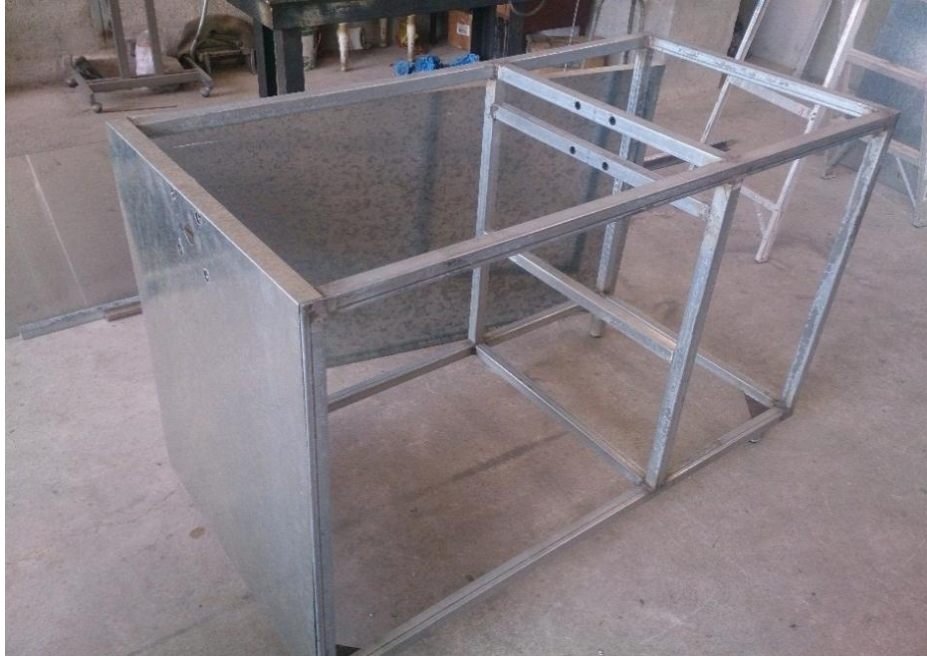
Estructura y soporte del Sistema de Centrifugado
