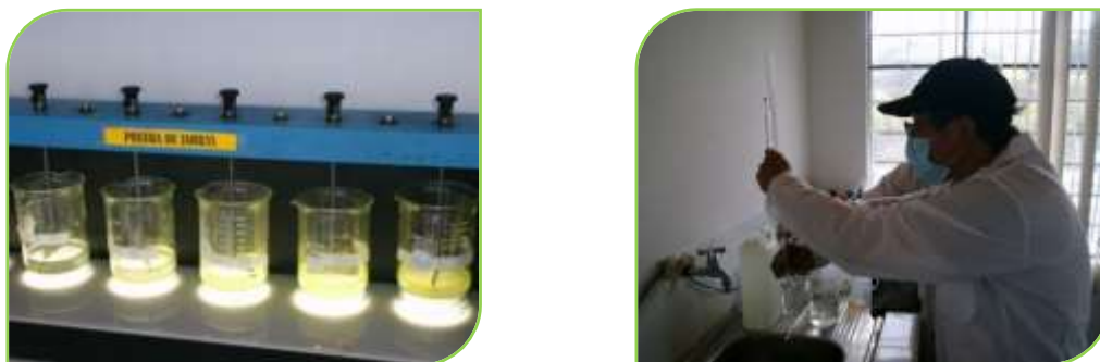
Figura 3.12: Prueba de Jarras realizada a diferentes revoluciones y obtención de muestras Fuente: Fuentes, 2016
