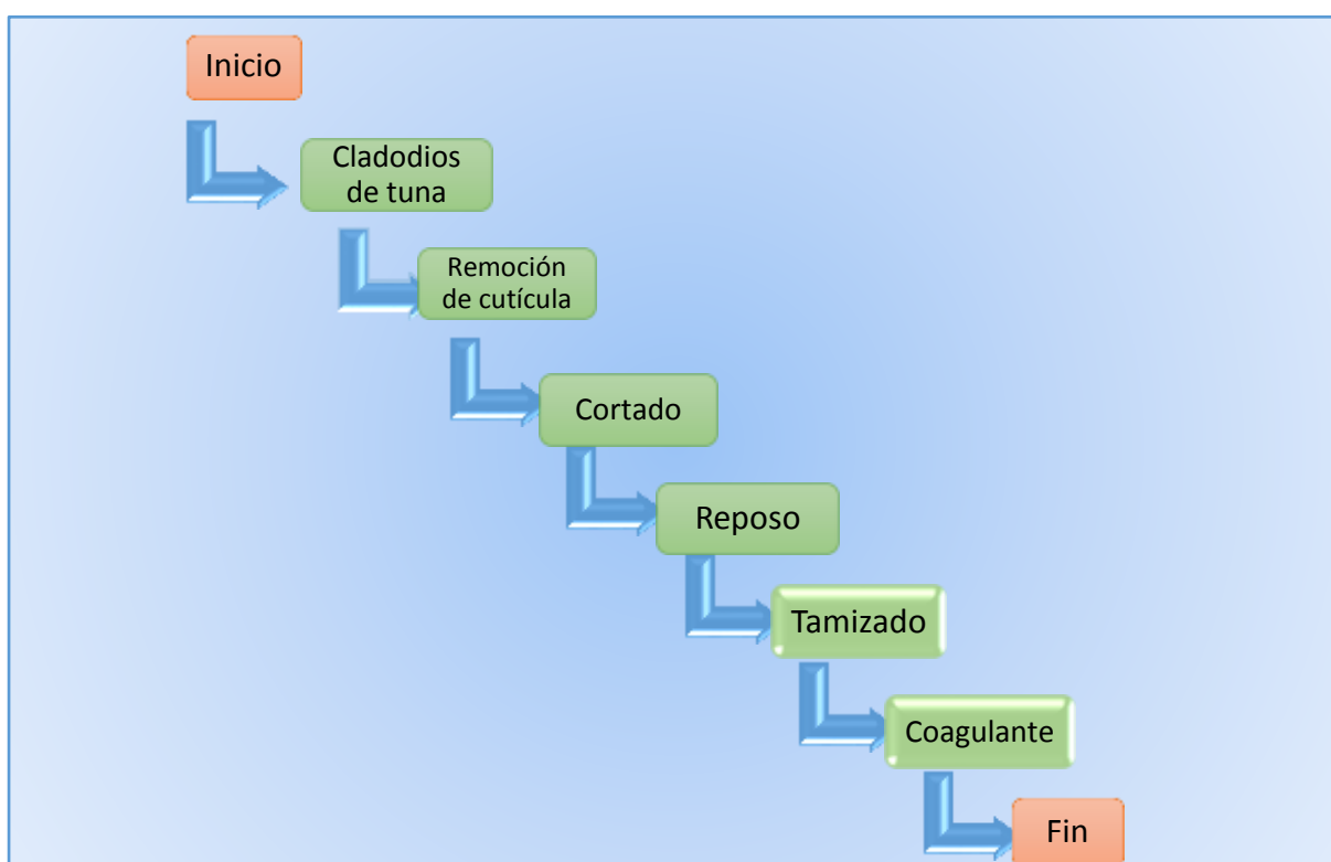
Figura 3.10: Diagrama de flujo del proceso de obtención del coagulante. Elaborado por: Javier Morejón.
