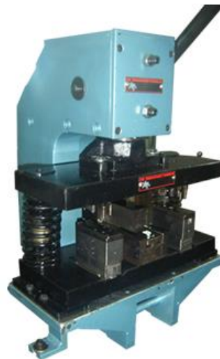
Gráfico 3 Máquina Troqueladora Manual
