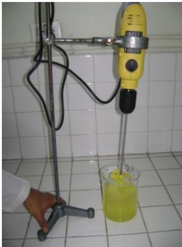
**Fotografía 20** Agitador mecánico de 90 y 180 rpm
