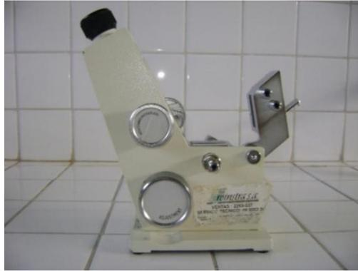
**Fotografía 6** BrixómetroAbbé con escala de 0 a 32 °Brix
