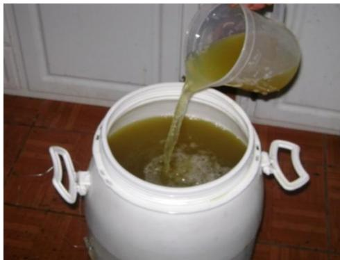
**Fotografía 19** Adición de la cepa de levadura, para la fermentación
