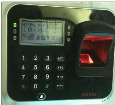
*Figura 45:* Lectora de huella digital para control de acceso en el Data Center de la COAC Chuchuqui Ltda.
