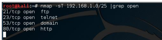
Figura 16: Comando para escaneo de puertos abiertos en la red mediante nmap en Kali Linux
