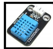
Figura 12. Sensor Temperatura Ambiente y Humedad Relativa DHT11
