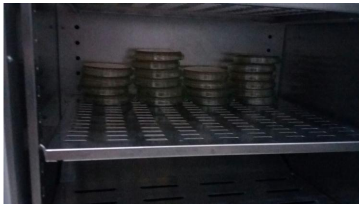
Gráfico 57: Cámara de incubación con cajas de cultivo
