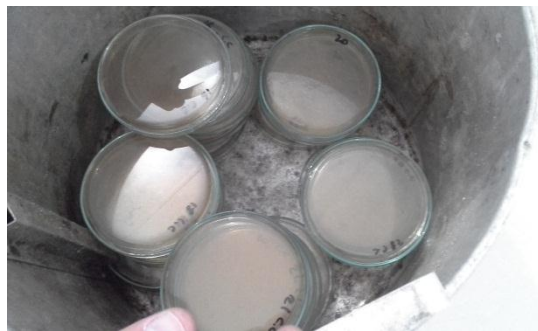
Gráfico 60: Esterilización de las cajas de cultivo
