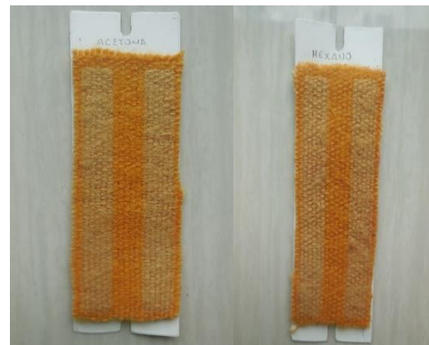
Fotografía 1. Lana tinturada con colorante extraído a partir de cuerpos fructíferos con acetona y hexano, expuesta a 20 horas de luz artificial.
