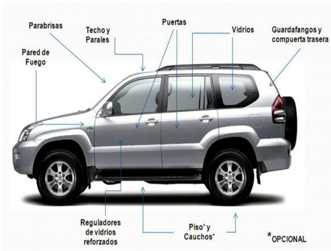
Gráfico 10 Áreas de Blindaje de un Vehículo
