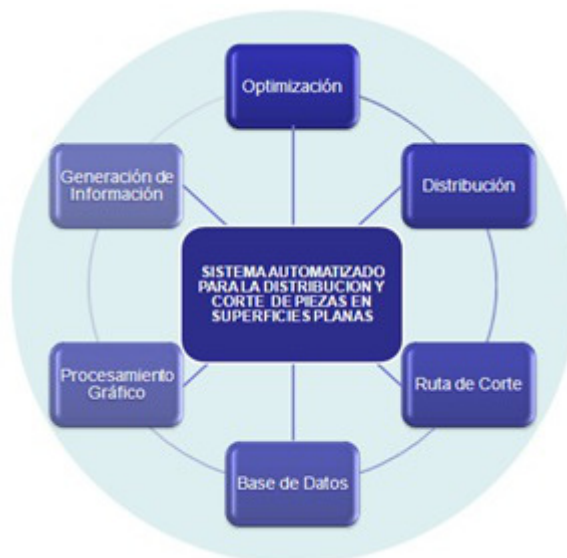
Figura 8.10: Esquema conceptual de un sistema CAD/CAPP para la distribución y corte de piezas en superficies planas.
