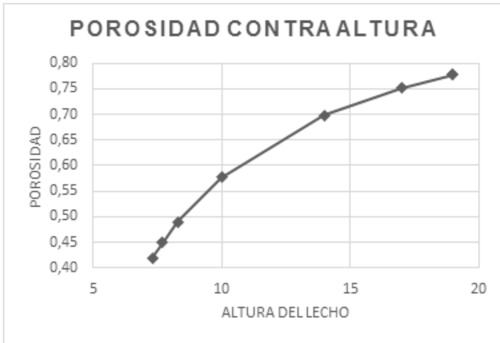
Figura 19.3: Porosidad contra altura del lecho
