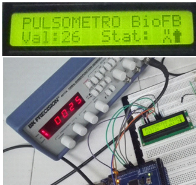
Figura 13.9: Presentación visual ante una entrada de tren de pulsos con una frecuencia de 25 Hz, como esta frecuencia es inferior a 30 Hz se presenta un estado triste y una flecha hacia arriba indicando que se debe subir las pulsaciones.
