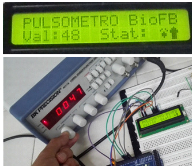
Figura 13.10: Presentación visual ante una entrada de tren de pulsos con una frecuencia de 47 Hz, como esta frecuencia esta entre el rango de 30 a 60 Hz se presenta un estado sorprendido y una flecha hacia arriba indicando que se debe subir las pulsaciones.
