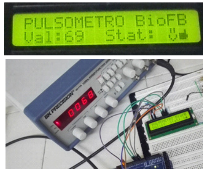
Figura 13.11: Presentación visual ante una entrada de tren de pulsos con una frecuencia de 68 Hz, como esta frecuencia esta entre el rango de 60 a 80 Hz se presenta un estado feliz y una mano alzando el pulgar que indica que el estado del paciente es el deseado por el especialista.
