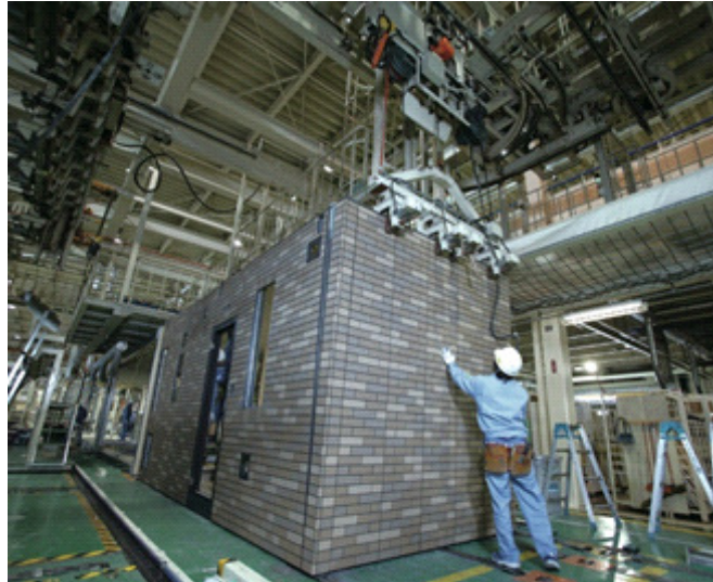
Figura 25.2: Ensamblado en fábrica de una unidad de casa modular. (Source: Sekisui Chemical Co. Ltd.)
