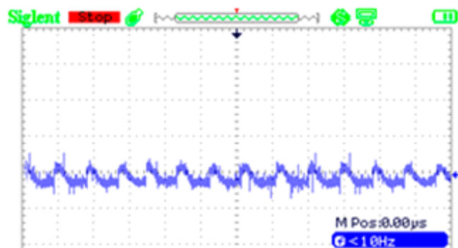
Figura 13.7: Señal pletoisomográfica obtenida con el diseño del sensor 3 en la cual se puede apreciar la onda pletoisomográfica después del filtrado realizado.
