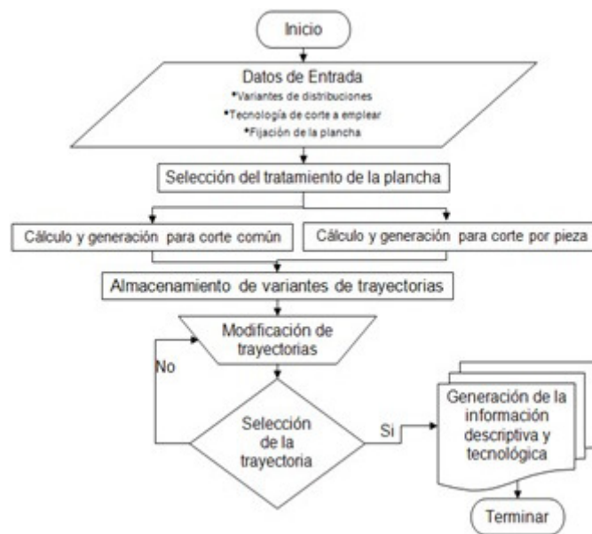
Figura 8.9: Algoritmo general del sistema para el corte de piezas en chapas.
