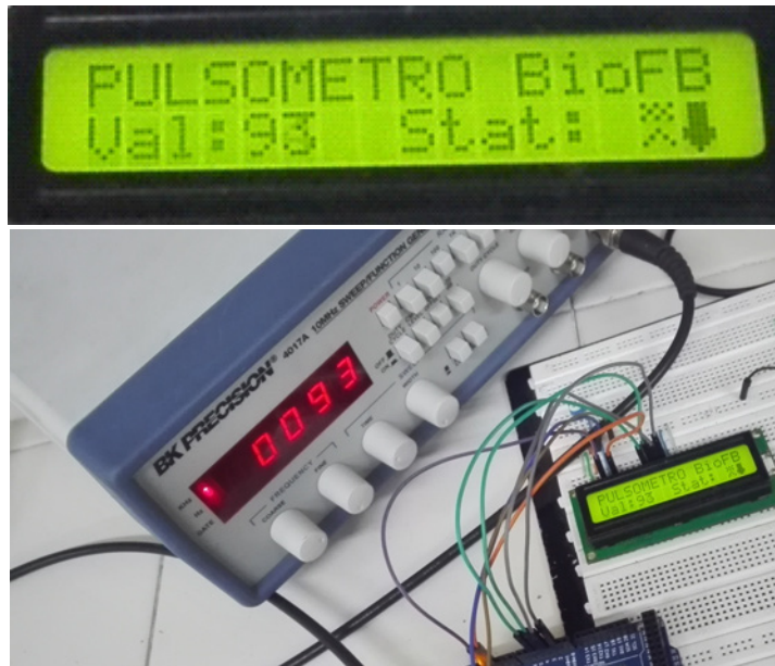
Figura 13.12: Presentación visual ante una entrada de tren de pulsos con una frecuencia de 93 Hz, como esta frecuencia es superior a 80 Hz se presenta un estado de temor y una flecha hacia abajo indicando que se debe disminuir las pulsaciones.
