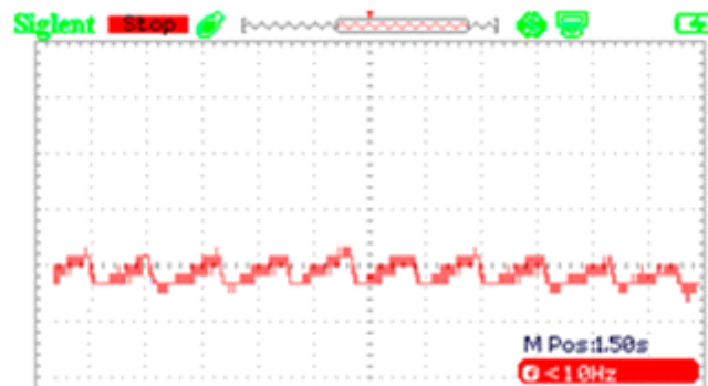
Figura 13.5: Señal pletoisomográfica obtenida con el diseño del sensor 1 en la cual se puede apreciar la onda pletoisomográfica después del filtrado realizado.
