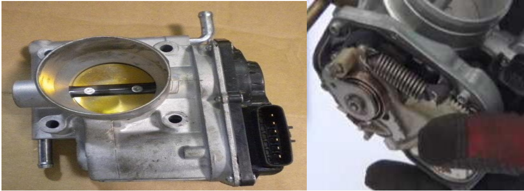
Figura 38 Cuerpo de acelerador electrónico Fuente: (Volkswagen AG, s.f.).
