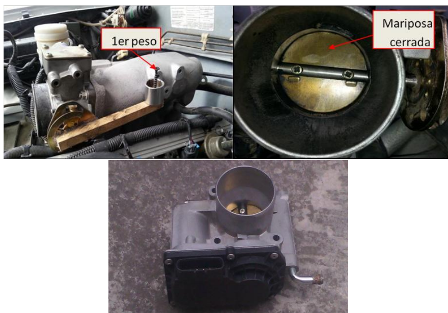
Figura 10 Periodo de prueba con un peso de 0,06587 kg.
