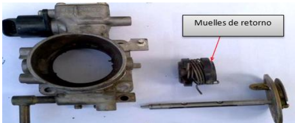
Figura 7 Desarme de la pieza de aceleración Fuente: (Quitama & Túlcan).
