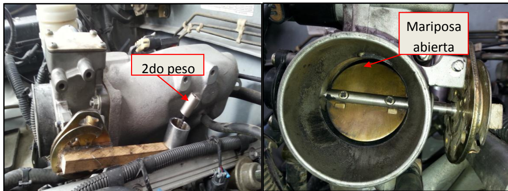
Figura 11 2do periodo de prueba con un peso de 0,0123kg. Fuente: (Solé, 2012)
