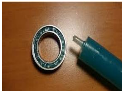
Figura 74. Mantenimiento de rodamientos
