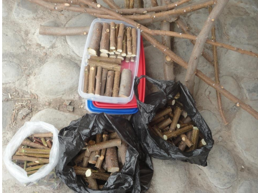
Foto 14. Muestras para determinar el % de humedad en laboratorio.
