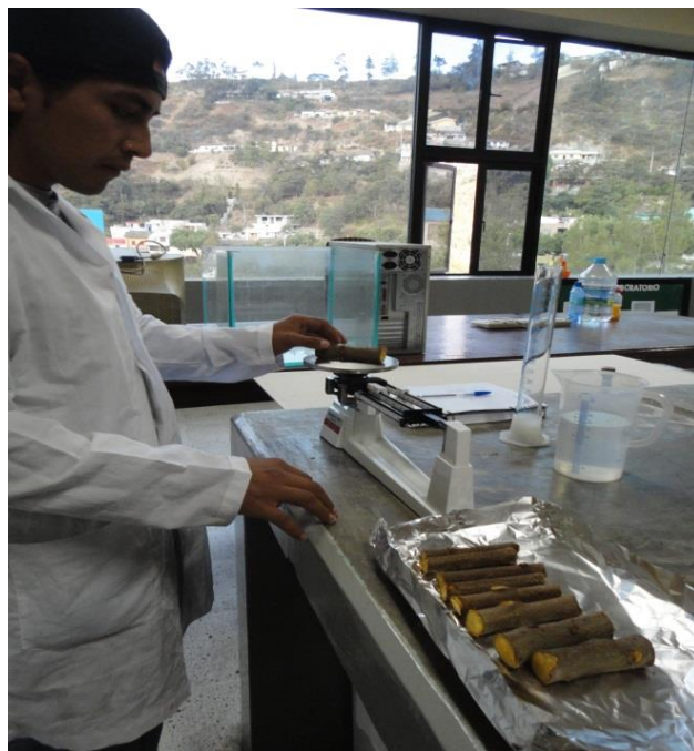
Foto 16. Determinación del peso seco.
