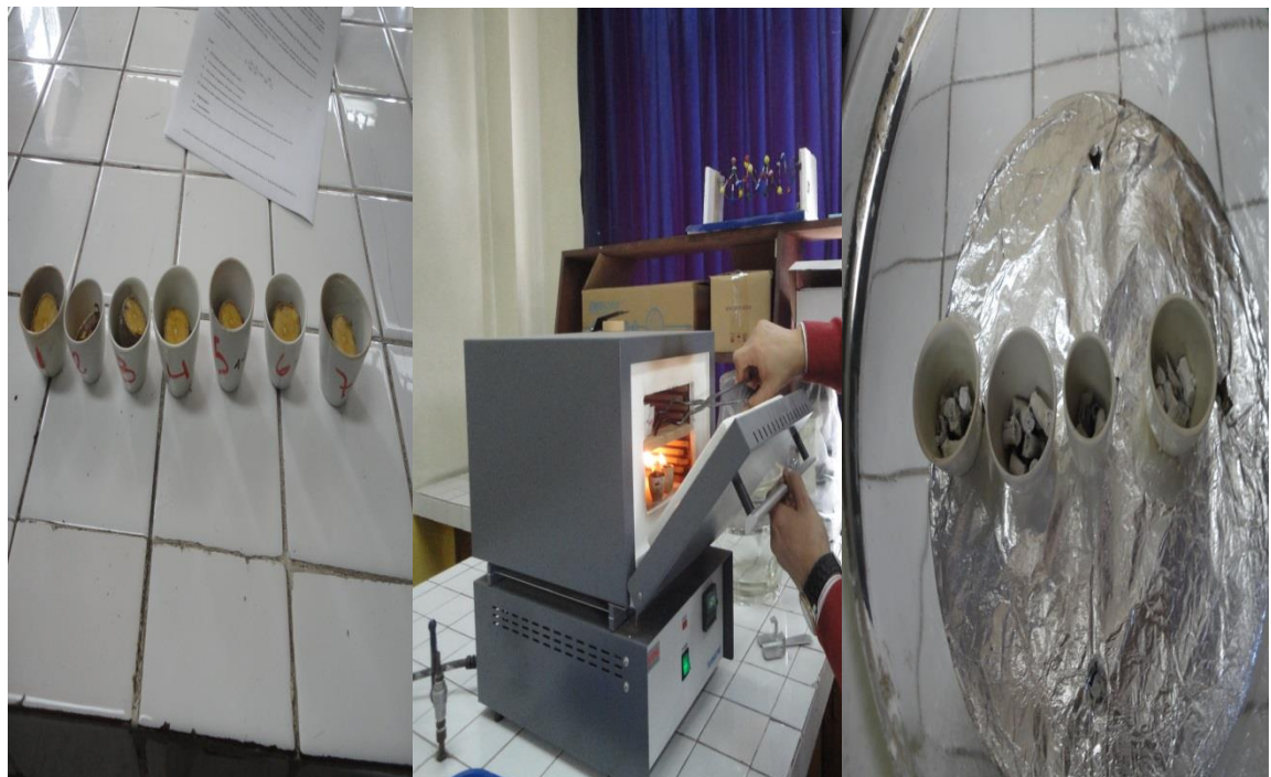
Foto 18. Determinación del % de cenizas en laboratorio.
