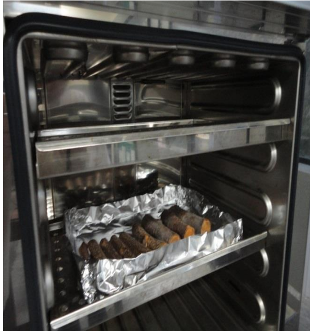
Foto 16. Determinación del peso seco.
