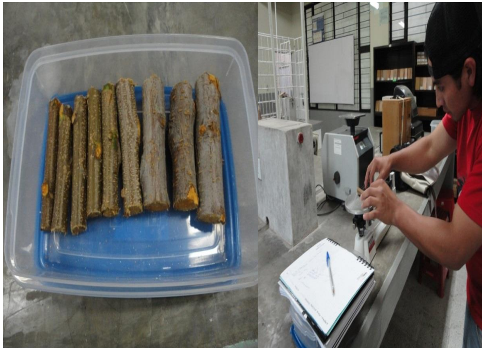
Foto 14. Muestras para determinar el % de humedad en laboratorio.
