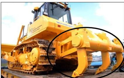
**1.-Roturar** el suelo con el tractor roturador (bulldozer) equipado con cinceles o dientes de 80 cm de longitud.
