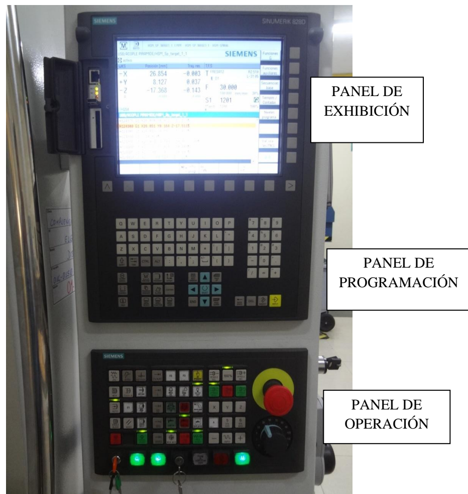
Figura 33. Panel de control SINUMERIK 828D
