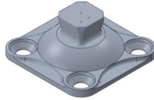
Figura 40. Vista isométrica del acople pirámide
