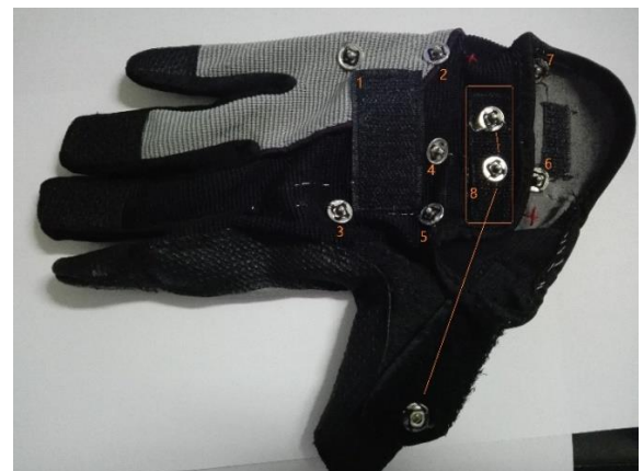
Figura 17. Conexión de los componentes Fuente: Autoría.
