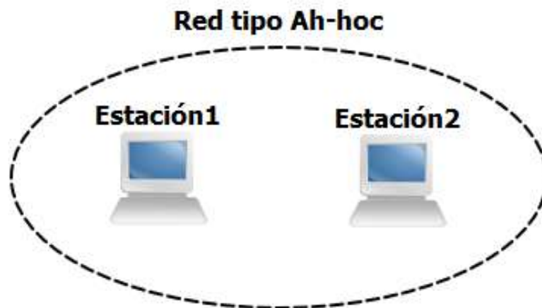
Figura 13. Topología de red tipo ad-hoc. Fuente: Propia
