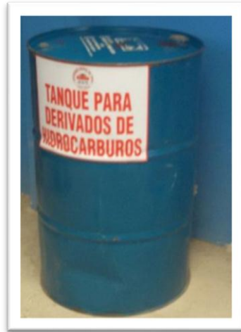
FIGURA 29: Tanque Metálico para recolección de aceite usado, combustibles, líquidos de frenos y aditivos.
