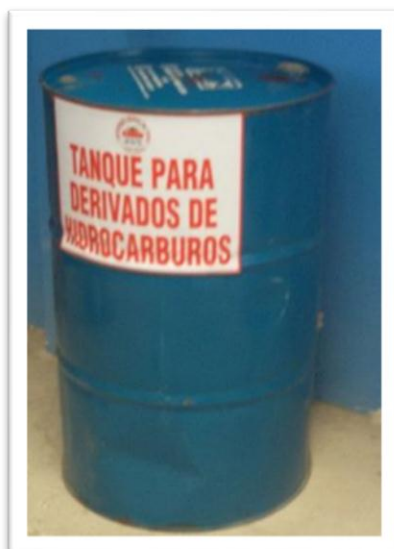
FIGURA 38: Tanque metálico para recolección de aceite usado, combustibles, líquidos de frenos y aditivos.
