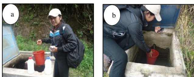
Figura 3. 5. Medición del caudal: a) Método volumétrico , b) Tiempo de llenado del balde, Elaboración: La autora
