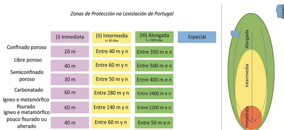
Figura 2.1. Perímetros de protección en función de las características geológicas Fuente: Life Rural Supplies, 2009
