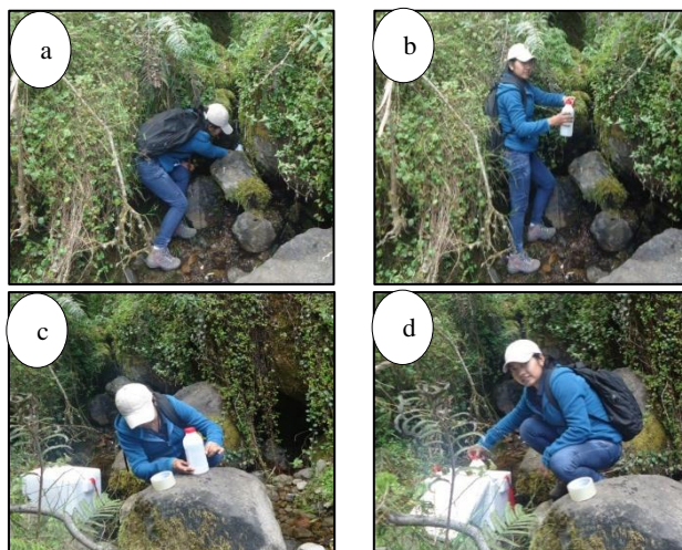
Figura 3. 4. Toma muestras de agua: a) Llenado del frasco, b) Sellado del frasco, c) Etiquetado del frasco, d) Frasco guardado en el cooler. Elaboración: La autora
