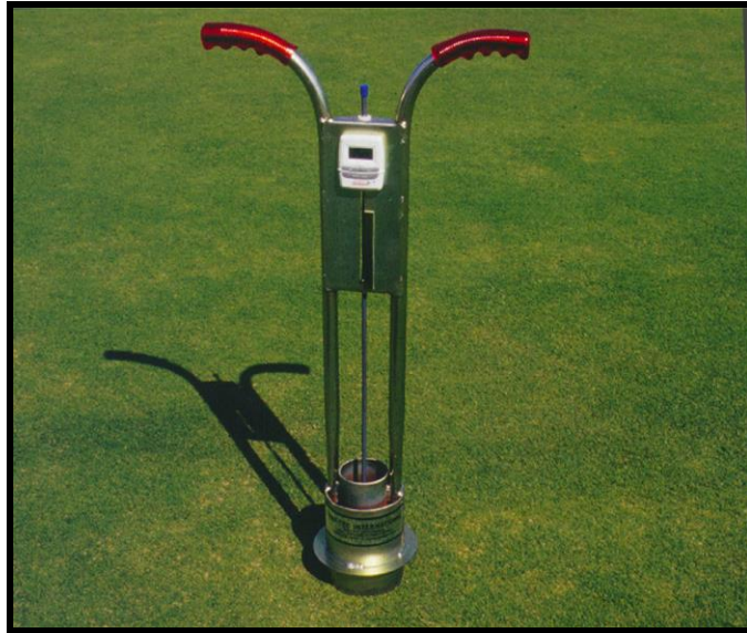
Figura 2.2. Infiltrómetro de Turf Tec
