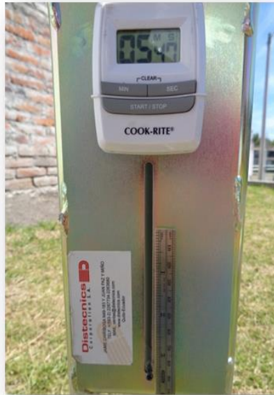
Fotografía 3.- Resultado de medición de la infiltración.
