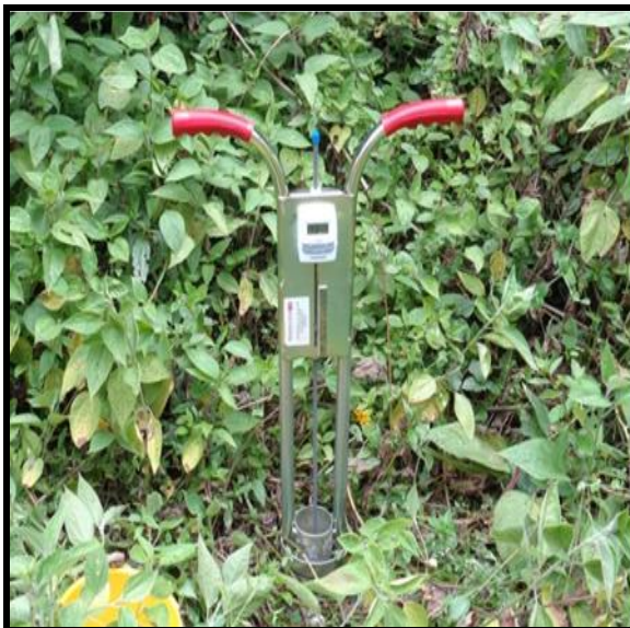
Figura 3.3.- Prueba de Infiltración en vegetación arbustiva
