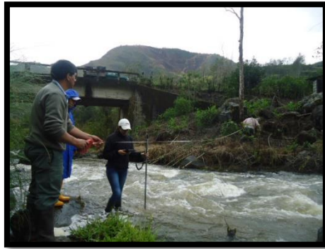
Figura 2. Medición de caudal
