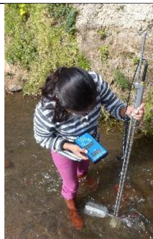
Figura 4.57. Medición de caudal con molinete electrónico.
