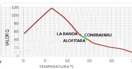
Figura 4. 47 ICAS-NSF Valor Q Temperatura Fuente: Samboni, et al. (2007) V. Conrrayaru Q =45 T. Alofitara Q =40 A. La Banda un valor Q =50
