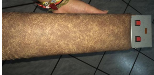
Figura 4. 25 Apoya brazo de la silla de ruedas con el sistema de control.
