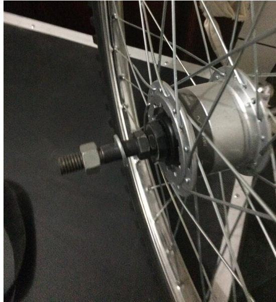
Figura 4. 16 Extensión de eje de la silla de ruedas
