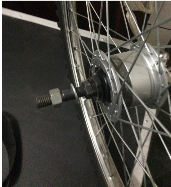
Figura 4. 11 Acople con el dinamo de manzana.
