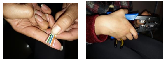
Figura 8. Ponchado del par trenzado
