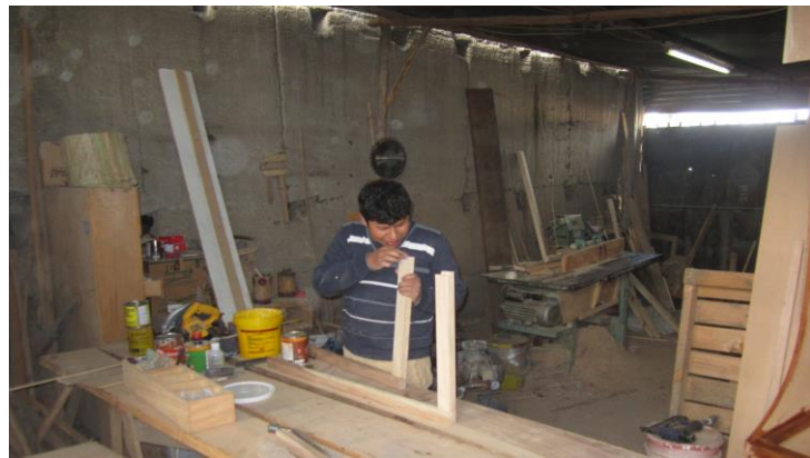
Fig. 4 Ensamblado de una ventana en madera de eucalipto ( eucaliptus globulus )
