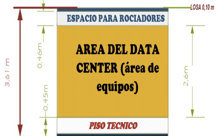
Figura 2: Infraestructura del Data Center Fuente: Autor
