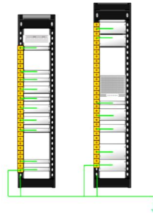
Figura 15: Conexión de los racks a la malla de puesta a tierra Fuente: [13]
