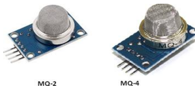
Figura 8. Sensores de humo MQ Fuente: (yapo, 2017)
