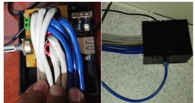
Figura 15 Colocacion del Arduino en la caja. Fuente: Propia
