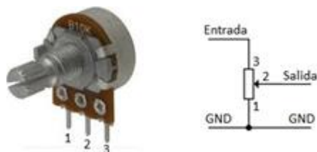
Figura 1. Esquema del potenciometro. Fuente: [6]
