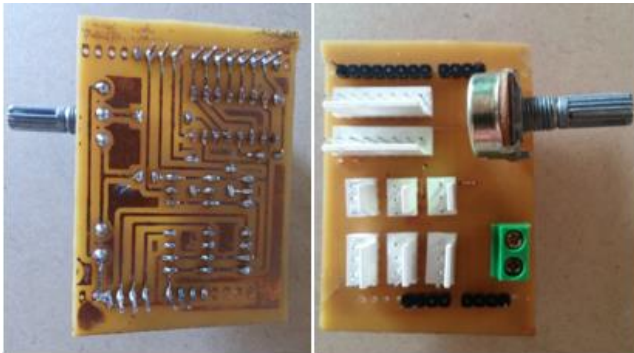
Figura 13 Armado de placa que encaja en el arduino YUN. Fuente: Propia.
