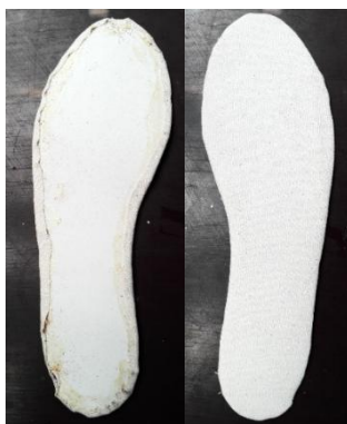
Figura 33 Bordos de plantilla de tela adheridos a borde de plantilla de goma EVA. Elaborado por: Daniela Lara.
