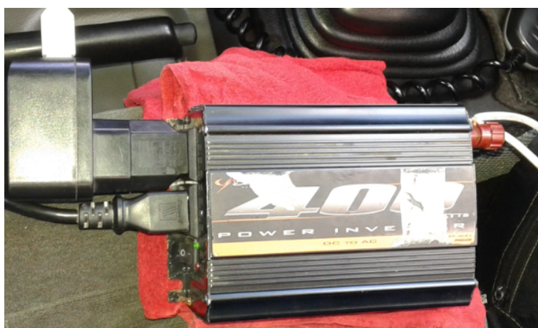
Ilustración 52 Pruebas de funcionamiento del inversor Fuente: (Autores)
