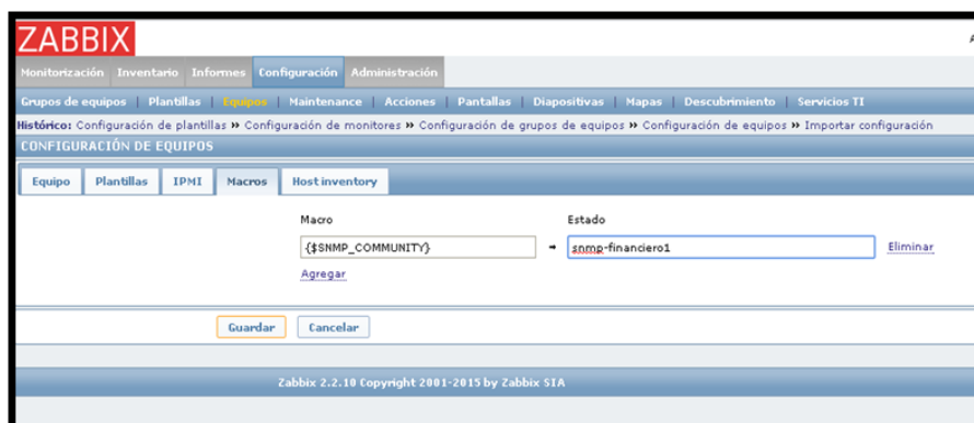
Figura C. 127 Especificando comunidad SNMP para los equipos
