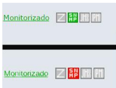
Figura 31 Equipos activos y no activos con snmp Fuente: Obtenida de la plataforma Zabbix
