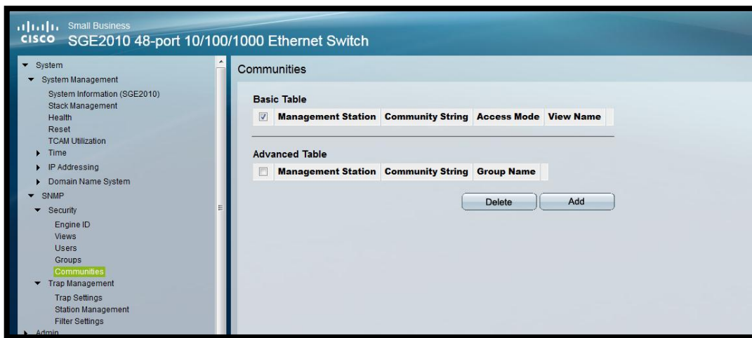
Figura D. 25 Agregar nueva comunidad snmp al switch
