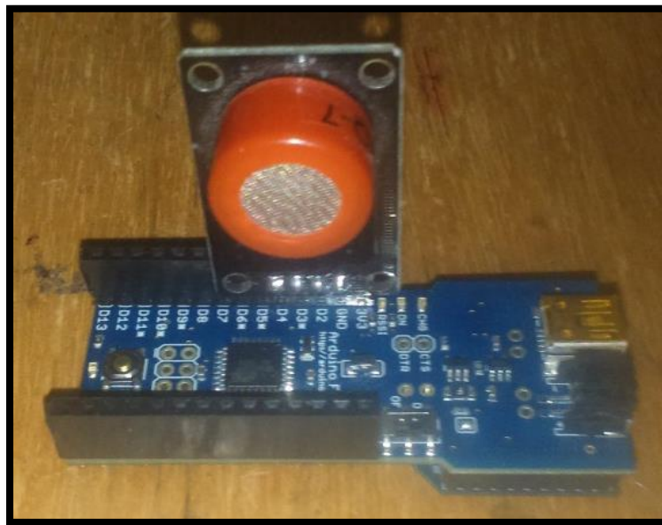
Figura 68. Modulo nodo Sensor
