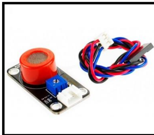
Figura 21. Sensor MQ-7 Monóxido de Carbono Fuente: http://www.openhacks.com/page/productos/id/102
